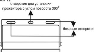
В зависимости от способа установки подготовьте место установки. Снимите кронштейн выкрутив боковые винты, закрепите кронштейн прожектора на монтажной поверхности. Установите прожектор на кронштейн.
